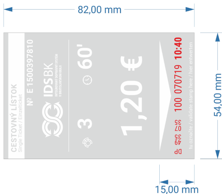
Obr. 22 Rozmery cestovného lístka a pole pre tlač údajov označovačom
