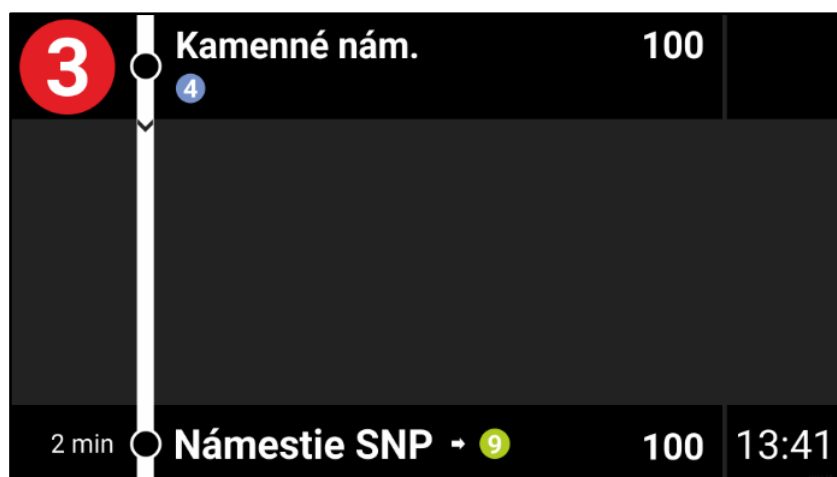
Vizuál obrazovky Trasa linky na prejazdovej linke pred koncom trasy, grafické zobrazenie trasy pokračuje po spodný okraj displeja
